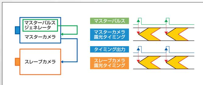
※ 2台のカメラを同期させて使用する場合、マスターカメラとスレーブカメラの露光タイミングを容易に合わせることができます。
