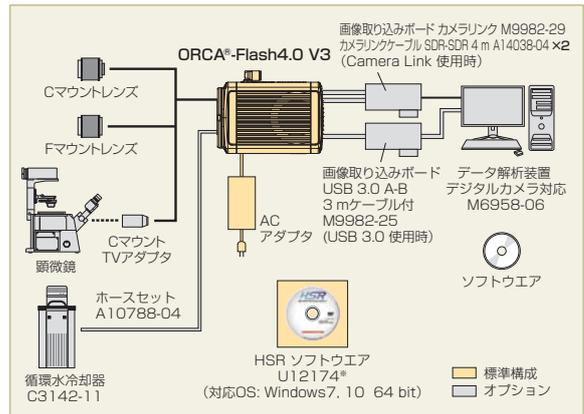
※HSR (High Speed Recording) は、カメラに標準で付属する画像取得ソフトウェアです。
