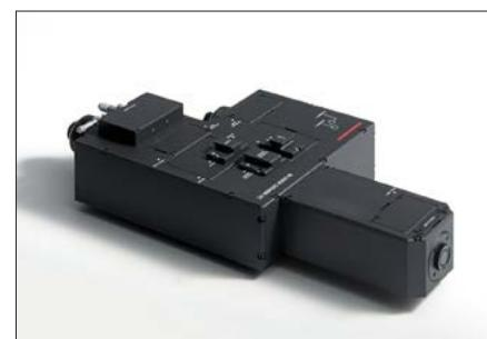
W-VIEW GEMINI-2Cは、入射光画像を2波長に分光し、それぞれの画像を2台のカメラに結像させる蛍光顕微鏡用イメージングプリッティング光学系です。自社開発した専用レンズの採用により、イメージエリアφ12 mm以内は回折限界が維持でき、2波長同時イメージングを超解像性能で実現します。
